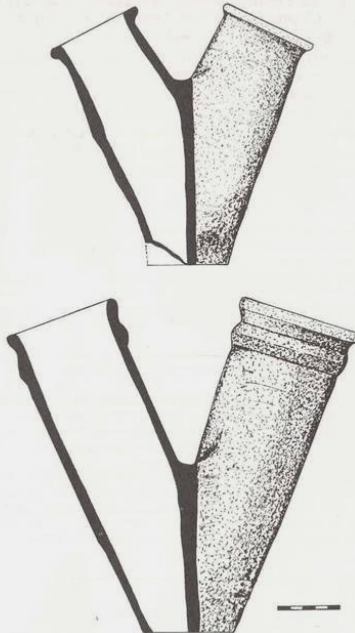
Fig. 4. : Tuyères provenant de l'oppidum de Pech Maho à Sigean (Aude), (l'exemplaire du bas est restitué).
